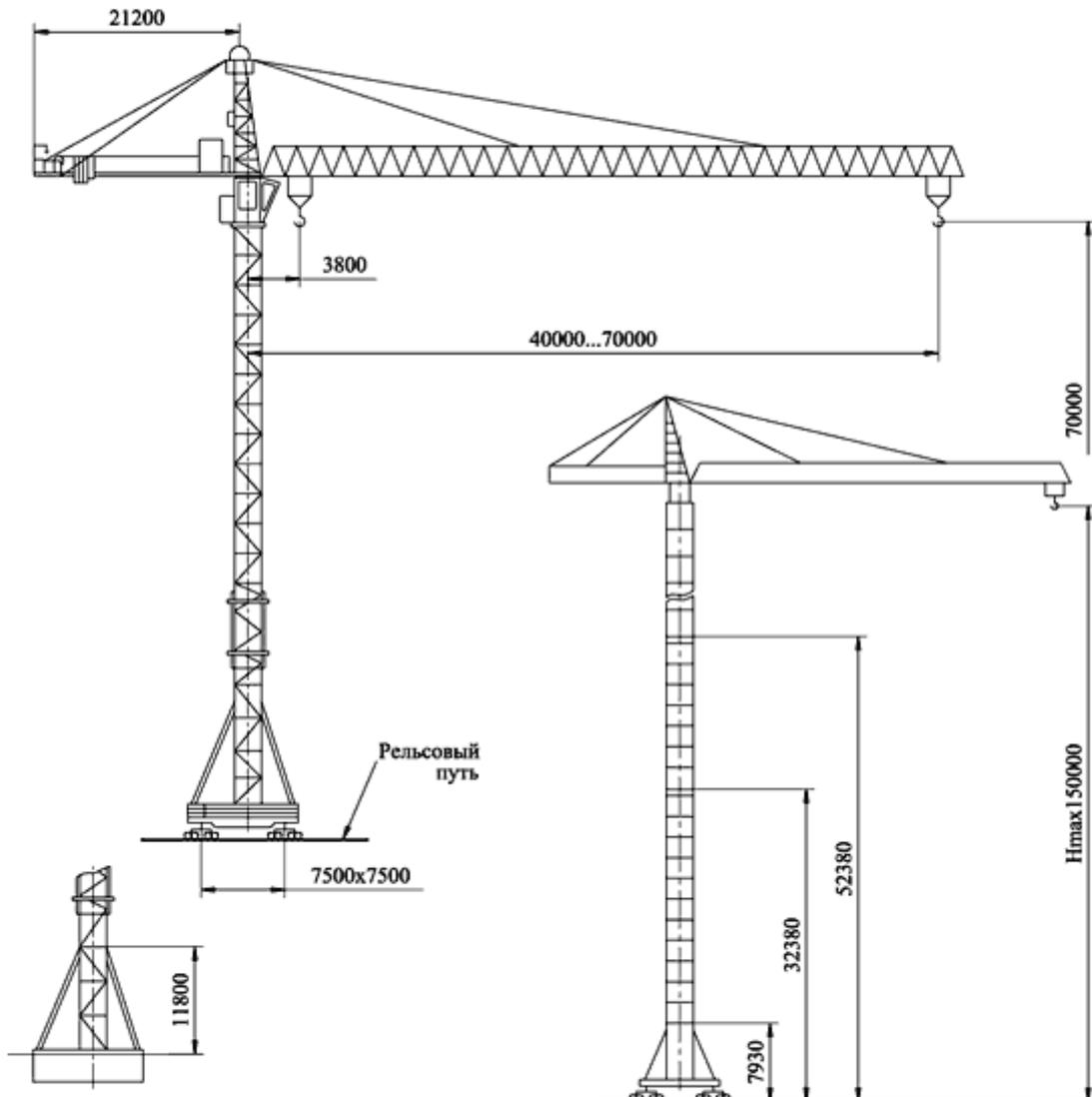
Схема установки крана на фундамент
